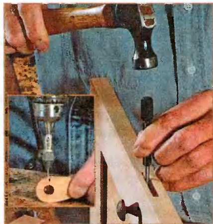
Щеколду и ручку закрепите штифтом. Вместо клея воспользуйтесь маленьким гвоздиком без шляпки или штифтом. Его можно забить с помощью добойника.
