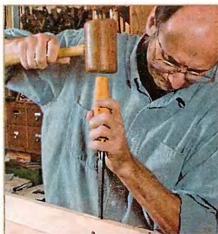
Выборка паза ведётся вручную.
