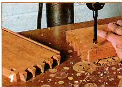
Гнездо под магниты-фиксаторы сверлят до склейки корпуса.
