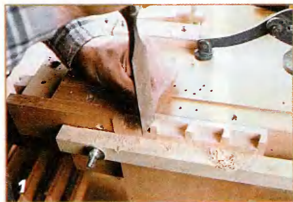
Рис. 1. Регулируемое приспособление для нарезки «ласточкиных хвостов».
