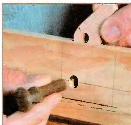
Ручка должна вставляться с небольшим усилием, а щеколда поворачиваться свободно и в открытом положении её не должно быть видно.
