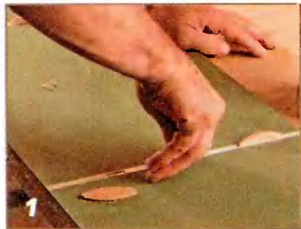
Соединения на шпонках типа «бисквит» — прочные и их можно быстро сделать.
