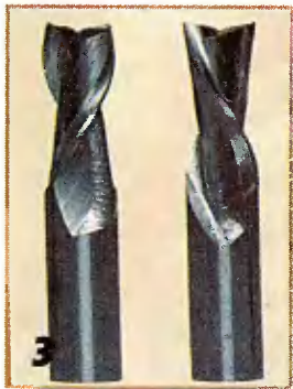
Слева — фреза с правым наклоном режущей кромки, справа — фреза с левым наклоном режущей кромки.
