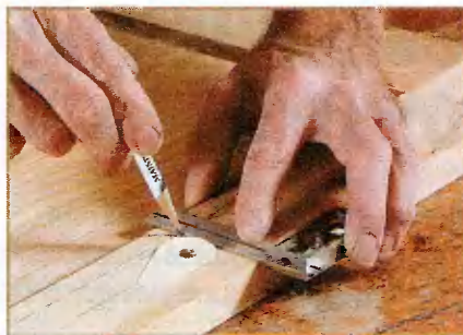
Просверлив в середине стойки отверстие для ручки, по картонному шаблону определите положение щеколды и с припуском 1,5 мм разметьте для неё паз.
