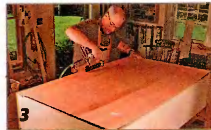
Заднюю 6-мм фанерную стенку можно прикрепить степлером.
